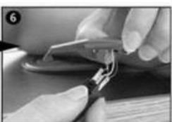
2 Fjern hetten på sylinderrampen for å synliggjøre nålen.
