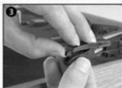
3 Løsne forsiktig pickuperen fra hodet.
