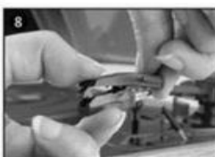
Scollegare completamente le linee audio dalla cartuccia.
