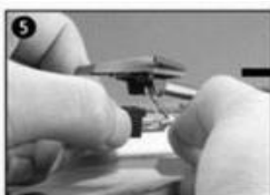
Spingere il blocco per liberare il braccio del giradischi.
