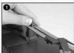
Spingere il blocco per liberare il braccio del giradischi.
