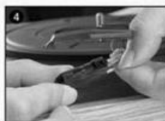
Scollegare completamente le linee audio dalla cartuccia.
