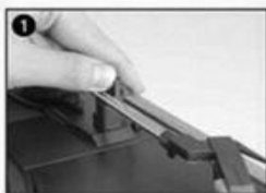
Naciśnij blokadę ramienia, by zwolnić ramię gramofonu.
