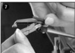
Delikatnie wyjmij wkładkę gramofonową z gniazda.
