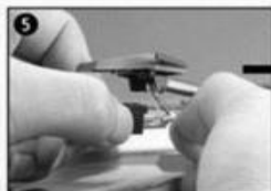
Naciśnij blokadę ramienia, by zwolnić ramię gramofonu.
