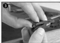
Delikatnie wyjmij wkładkę gramofonową z gniazda.
