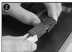
Zdejmij osłonę wkładki gramofonowej, by odsłonić igłę.
