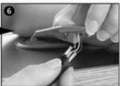
Remova a tampa do cartucho para expor a agulha.
